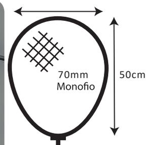
Cabeça para camaroeiro de mar, toda em alumínio e com rede monofilamento de 70mm. Macho com rosca universal, para cabos em fibra, em carbono ou em alumínio.
